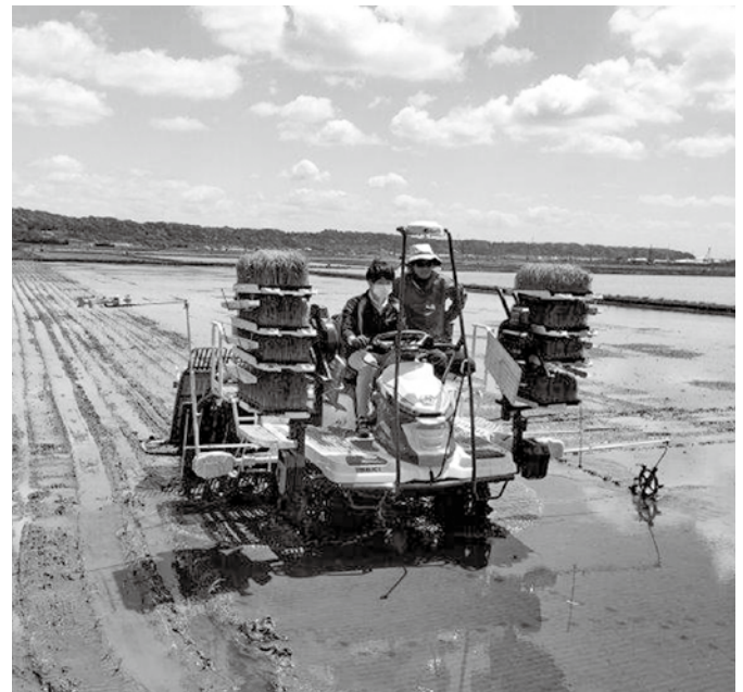
③直進アシストによりハンドルを持たずに作業ができる
