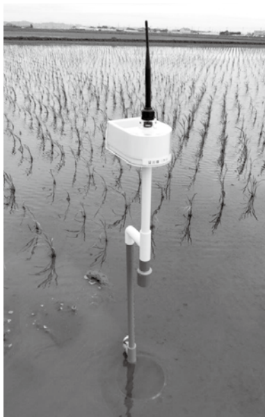
④水位センサーによる水位管理
